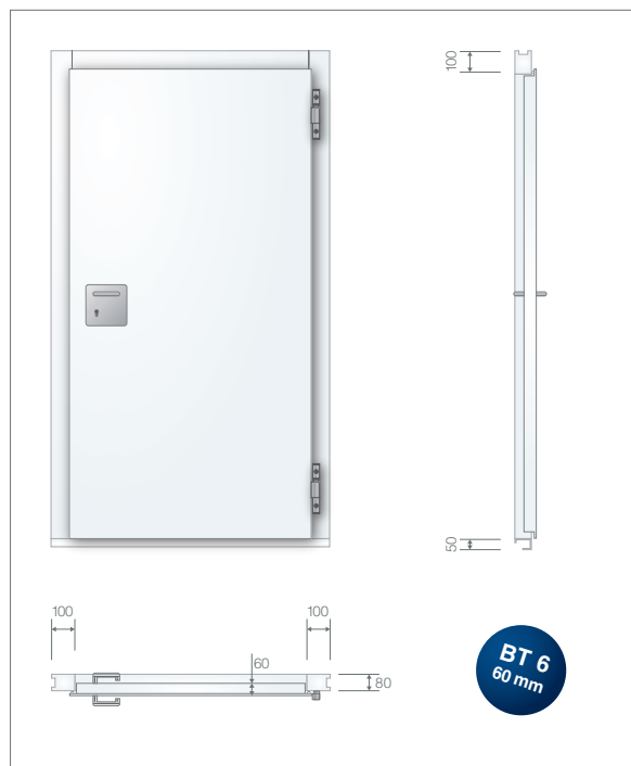
Drzwi obrotowe do pomieszczeń roboczych ze standardową ramą blokową (montaż w murze)
